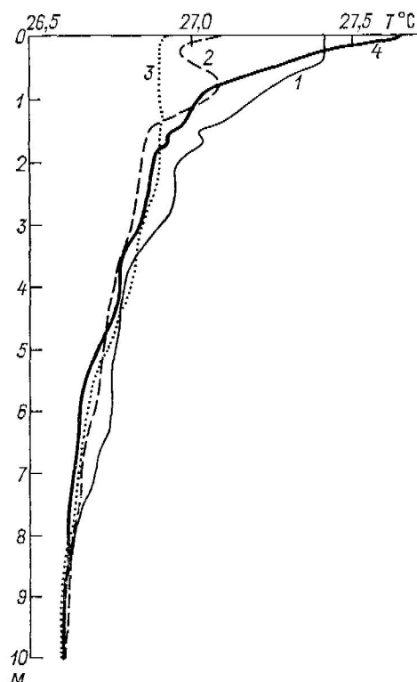
Рис. 3.46. Вертикальные профили температуры, полученные в штилевую погоду в Саргассовом море 25 сентября 1978 г. с помощью всплывающего зонда при слабом дрейфе судна (не более 0,5 уз).
