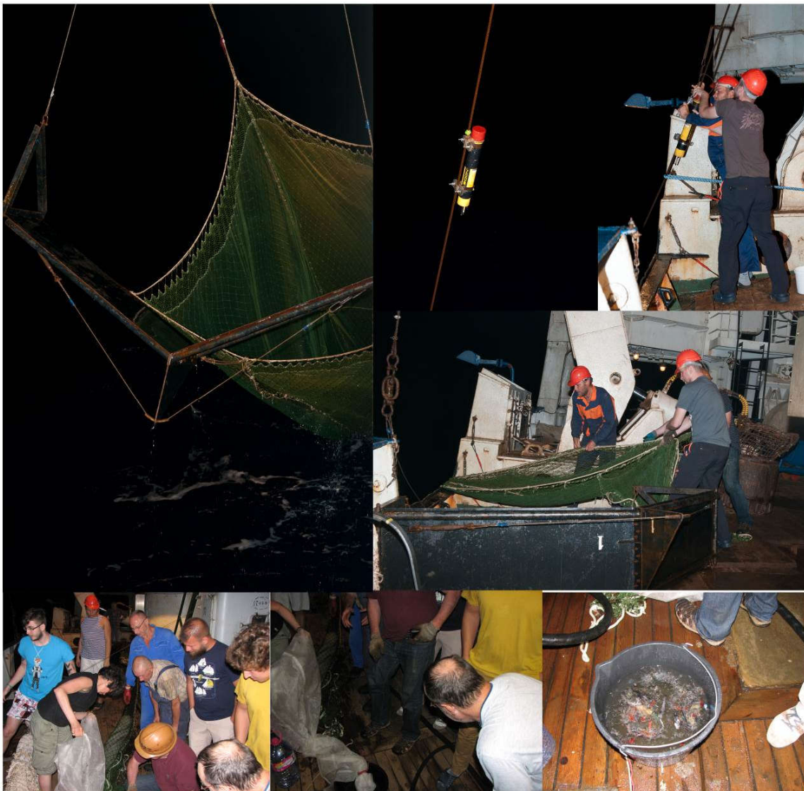
Рисунок 2.1.2. Сбор ихтиологического материала при использовании разноглубинного траля Айзекса-Кидда в модификации Самышева-Асеева (РТАКСА).
