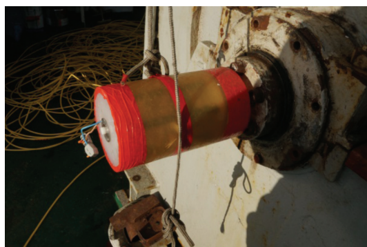
Рис. 6. Оптический вращающийся переход кабеля БНПА «Видеомодуль» на лебедке НИС «Академик Мстислав Келдыш».
