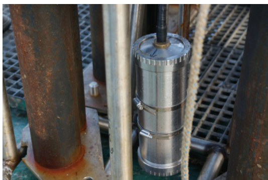
Рис. 3. Видеокамера БНПА «Видеомодуль» в прочном корпусе.
