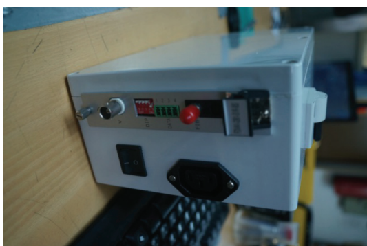
Рис. 5. Судовой электронный блок БНПА «Видеомодуль».
