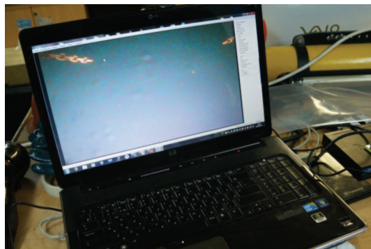
Рис. 4. Система отображения видеоинформации БНПА «Видеомодуль» в реальном времени.
